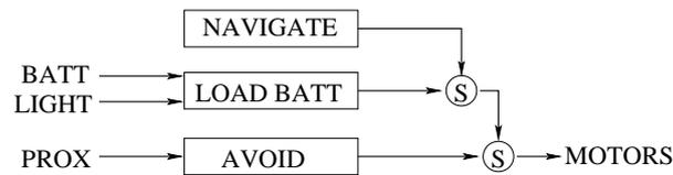
Figura 4.12: Arquitectura subsunción del experimento de navegación y carga.
